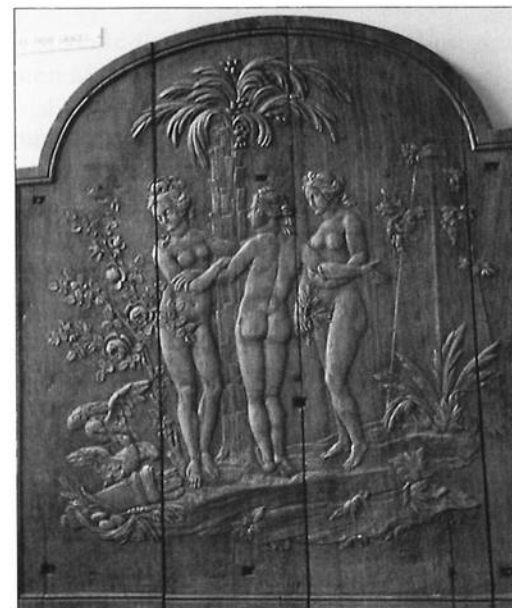
Mal waarnaar in zandbodem de haardplaat in gietijzer wordt gegoten.
